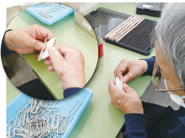
ベルト部分の部品にステンレスの金具を挟み貼り合わせています。
