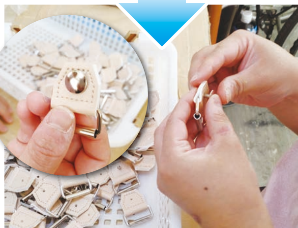
開けた穴にビスを入れる工程。奥まで金具を押し込みます。
