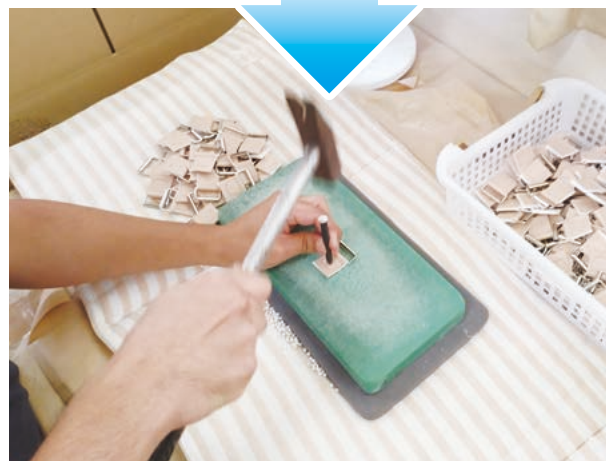
後工程の一つとしてハンコも使用して中心に穴を開けている様子。
